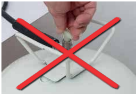
3. NE JAMAIS fermez le robinet du canister. Le flexible doit toujours rester sous pression.
