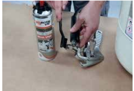
Pulvérisez suffisamment de dissolvant sur la buse et frottez avec une brosse douce.
