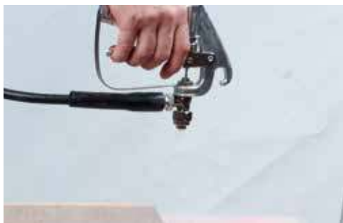
2. Videz complètement le flexible jusqu'à ce qu'il n'en sorte plus de colle, ni de gaz propulseur.
