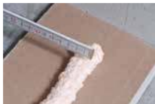
lijmstreng Ø 1 à 2 cm vlak op vlak verlijming
