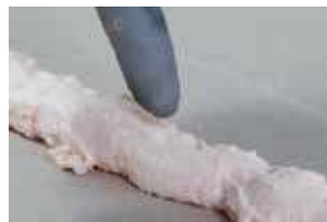
Velvorming: lijm voelt droog aan: te laat. Opnieuw lijm aanbrengen
