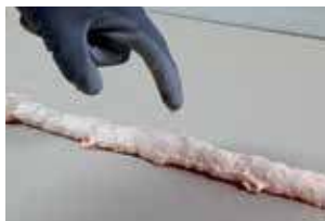
2. La couche de colle se fissure au contact : pouvoir adhésif insuffisant. • Easy Fix : après 3 min • Easy Fix Turbo : entre 0 et 1 min
