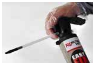
4. Détacher l'applicateur et l'orienter horizontalement
