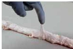
3. Formation des premiers fils, pouvoir adhésif suffisant pour les panneaux légers. • Easy Fix : après 5 min • Easy Fix Turbo : après 1 min
