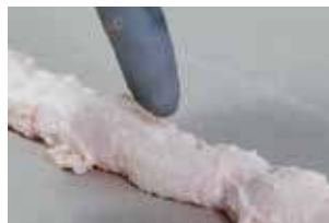
Formation d'une pellicule, la colle paraît sèche au contact : trop tard. Appliquer de la colle à nouveau
