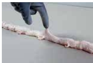
4. Formation de fils plus épais et plus nets : pouvoir adhésif suffisant pour les panneaux assez lourds. • Easy Fix : après 8 min • Easy Fix Turbo : entre 1 et 2 min
