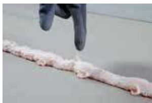
5. Formation d'une pellicule, trop tard pour la pose. • Easy Fix : après 10 min • Easy Fix Turbo : après 3 min
